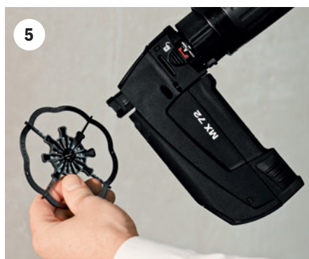
Aufsetzen von Baimit KlebeAnker X1. Durch die spezielle Geometrie hält dieser selbstständig.
