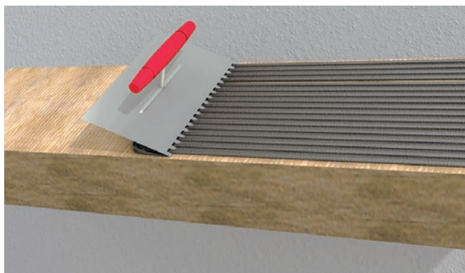
Abb. 26: Vollflächige Verklebung, schematische Darstellung anhand der Baumit BrandriegelPlatte Mineral
