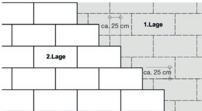
Abb. 28: Zweilagige Verlegung der Dämmplatten
