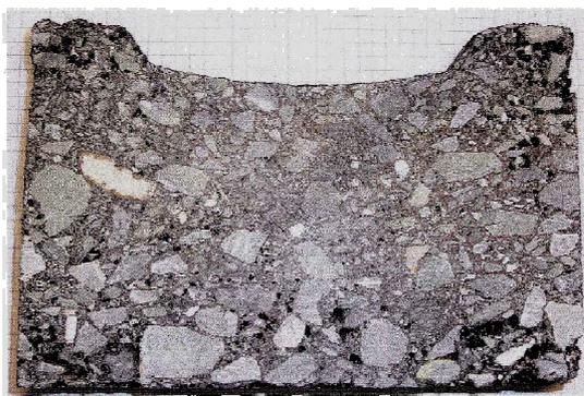
Abbildung 1: rechter Probekörper, Bohrkern 1 und 2 nach 30.000 Zyklen
