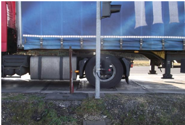
Die Messzelle im Betonfundament, angrenzend die halbstarre Decke
